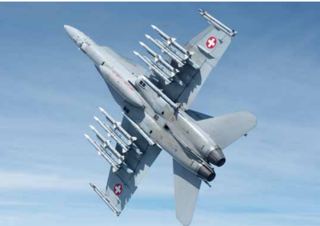
Die Bewaffnung des Kampfflugzeuges F/A-18C/D besteht aus (bis zu 10) Radarlenk Waffen für mittlere Entfernungen (AIM-120C-7 AMRAAM), zwei Infrarot-Lenk Waffen für kurze Entfernungen (AIM-9X Sidewinder) sowie der sechsläufigen 20-mm-Bordkanone.
